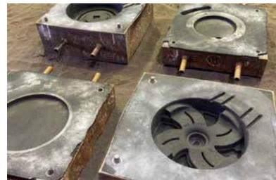
ポンプ用羽根車を製造するための砂型
